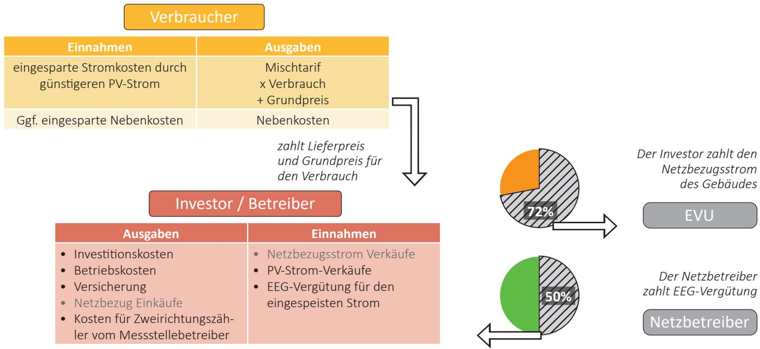
\* Die Solare Deckung (im Orange) beschreibt den selbst genutzten Strom aus der PV-Anlage im Verhältnis zum Gesamtstrombedarf (ganze Torte).
